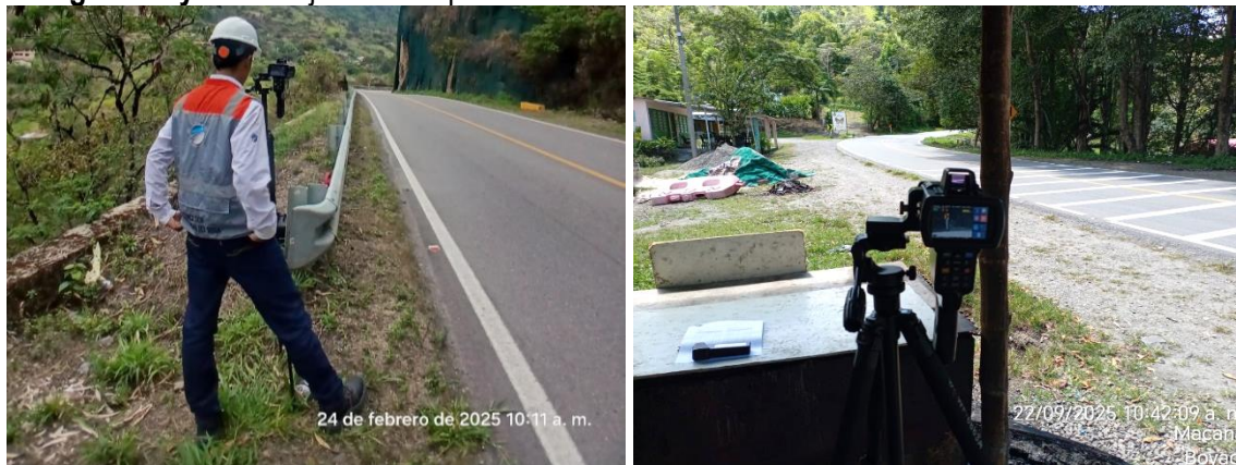
Fotografía 1 y 2. Trabajos en campo toma de velocidades con radar
